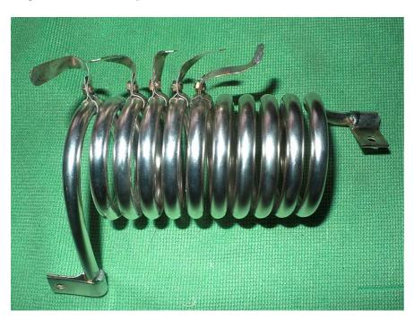
Può succedere che dopo questi lavori non si riesca ad accordare con le posizione prestabilite. È normale che siano variati i parametri del volano anodico. Si può provare a spostare le prese sulla bobina e tutto dovrebbe tornare come prima.
