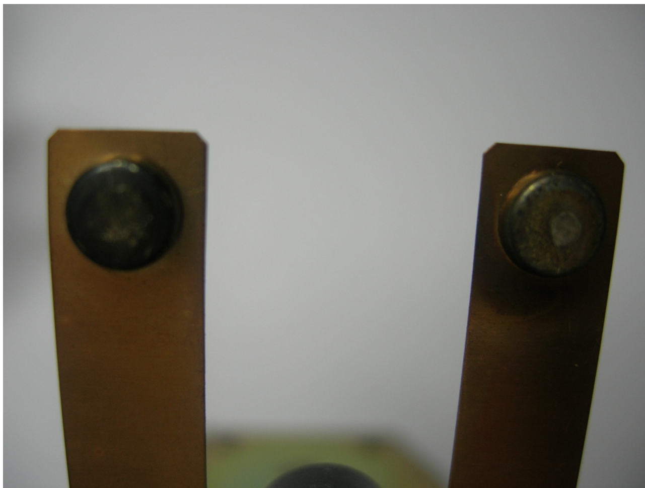
Fig. 4 – Altra visione contatti relè ma su parte mobile.
